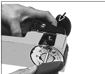
Appuyer sur le bouton de blocage (2) jusqu'à la butée et le maintenir enfoncé.
